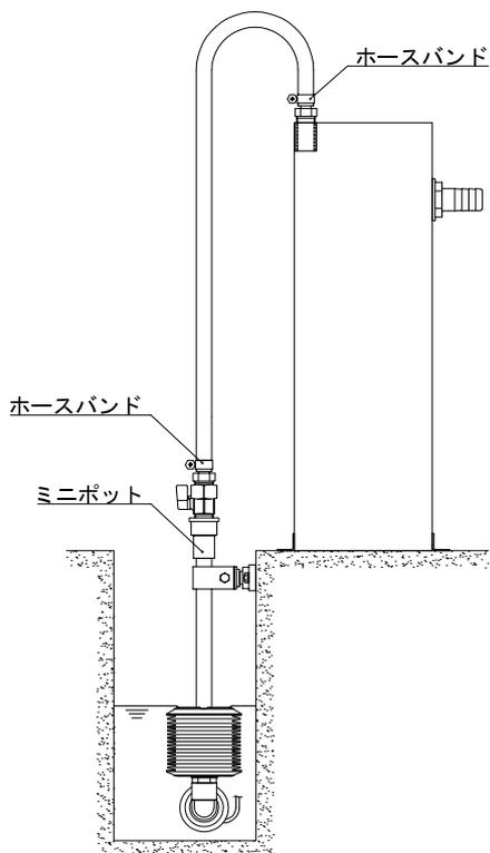
この時に余分な長さのホースは切断して、無理な折れ曲がりがないように最短の長さとして下さい。
