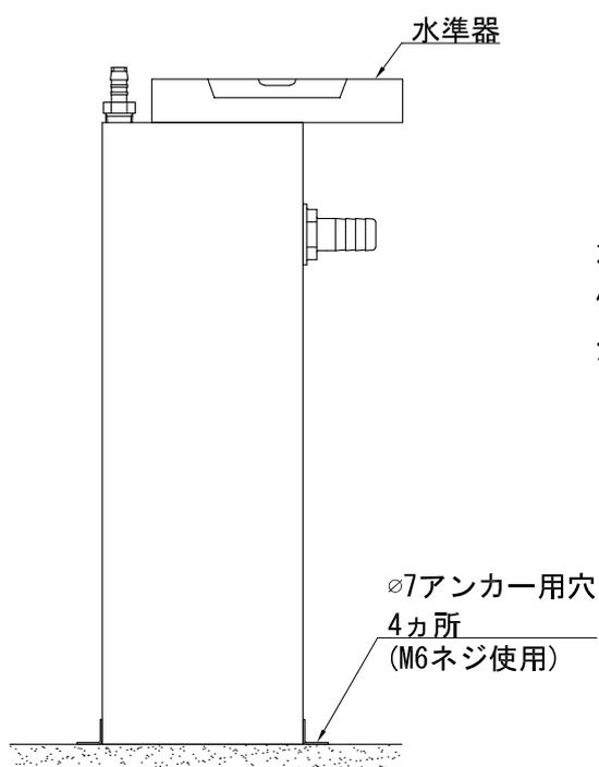
水準器等を利用して、分離槽が水平になるようにして下さい。傾いていると水と油の分離が十分に行われずそのまま排出され、分離した油が出にくくなります。
