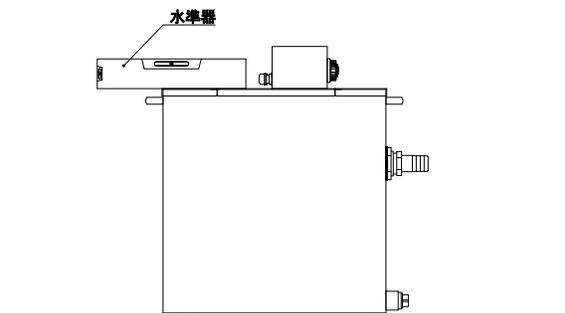
水準器等を利用して、ポンプユニット・分離槽ユニットが水平になるように設置して下さい。
