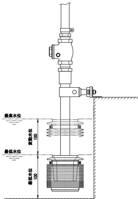
Qポットが最小に縮んだ時 (100mm) より最低水位が下になると液を吸い込めなくなり、空運転となりますので、最低水位を基準に取付け高さを決定して下さい。
