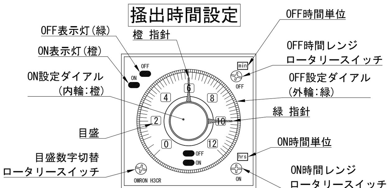
タイマーの設定時間を変更する場合には、必ず電源スイッチをOFFにしてから調整を行って下さい。
