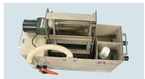
● 掻出しコンベア部
